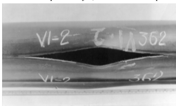
Fig. 1 – Rupere tipică pe cordonul de sudură; a. – vedere generală; b. – detaliu în zona de capăt
