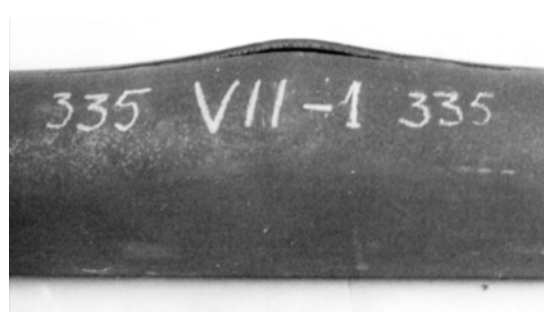
Fig. 2 – Rupere pe sudură la conducta de 125 mm
