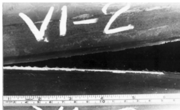
Fig. 1 – Rupere tipică pe cordonul de sudură; a. – vedere generală; b. – detaliu în zona de capăt
